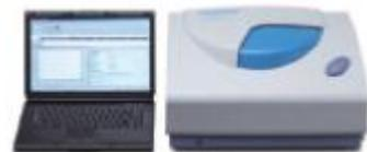
Un Zetasizer Horiba SZ-100Z va être installé au CBM. Cet appareil permet de mesurer la taille de particules
