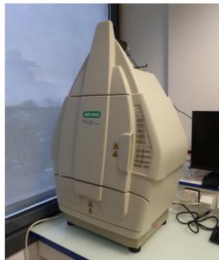
Un nouvel appareil d'imagerie, Gel Doc™ XR+ (Biorad), vient d'être installé au CBM. Il permet de visualiser les acides nucléiques et protéines sur gel ou membrane en UV, lumière blanche ou fluorescence avec une très grande sensibilité. Cet imageur a été cofinancé par le CoST Sciences et Techniques de l'Université d'Orléans, et sera utilisé aussi bien pour la recherche que pour l'enseignement.
